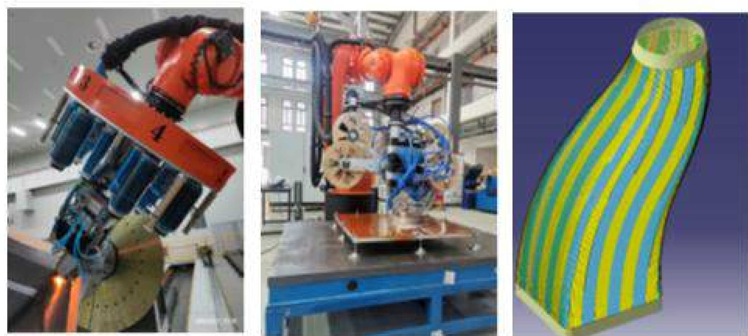
热固自动铺丝装备 热塑自动铺丝装备 自动铺放工业软件
